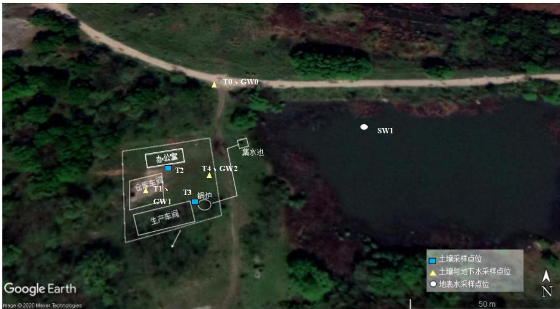
图 5.1-1 调查地块土壤及地下水、地表水采样点位图
