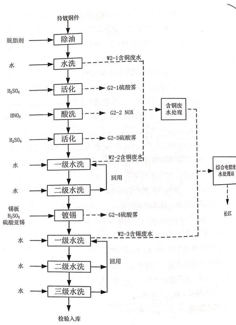
图 4-2 铜件镀锡半自动线工艺流程
