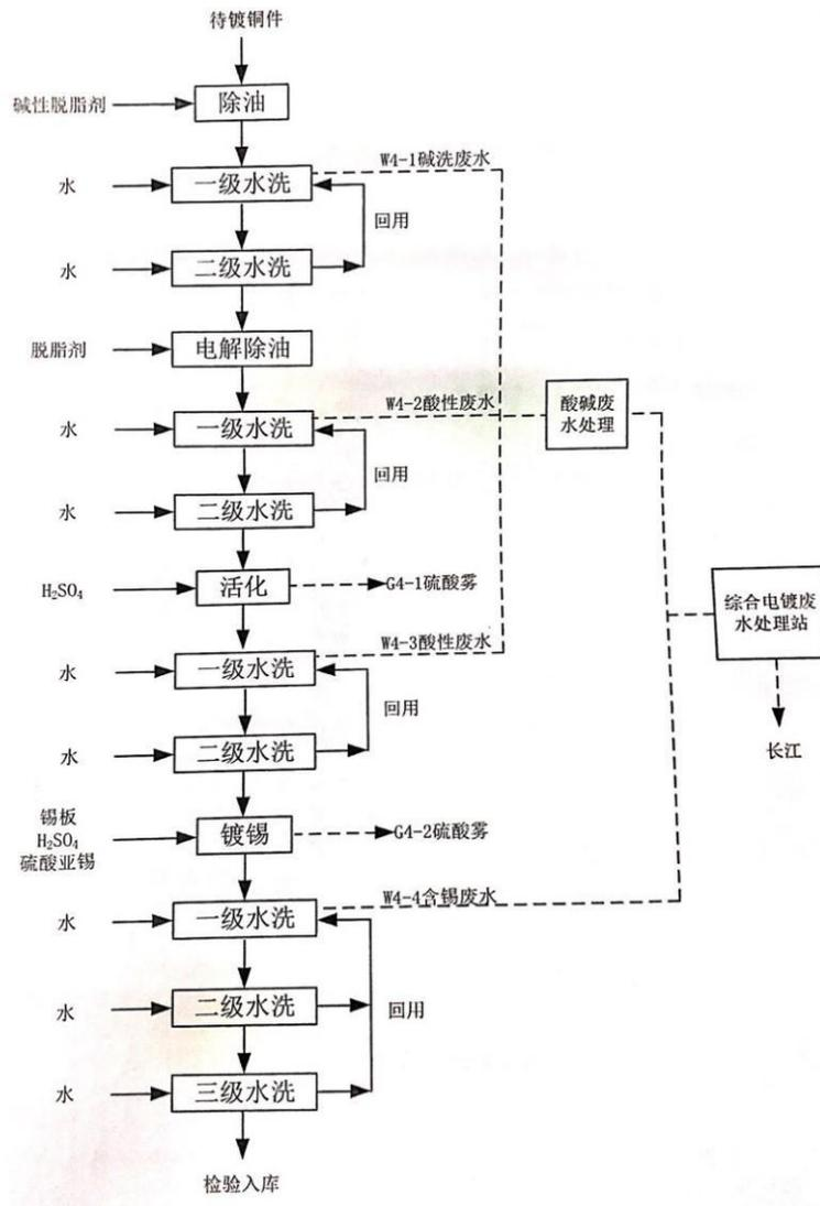
图 4-3 铜件镀锡自动线工艺流程
