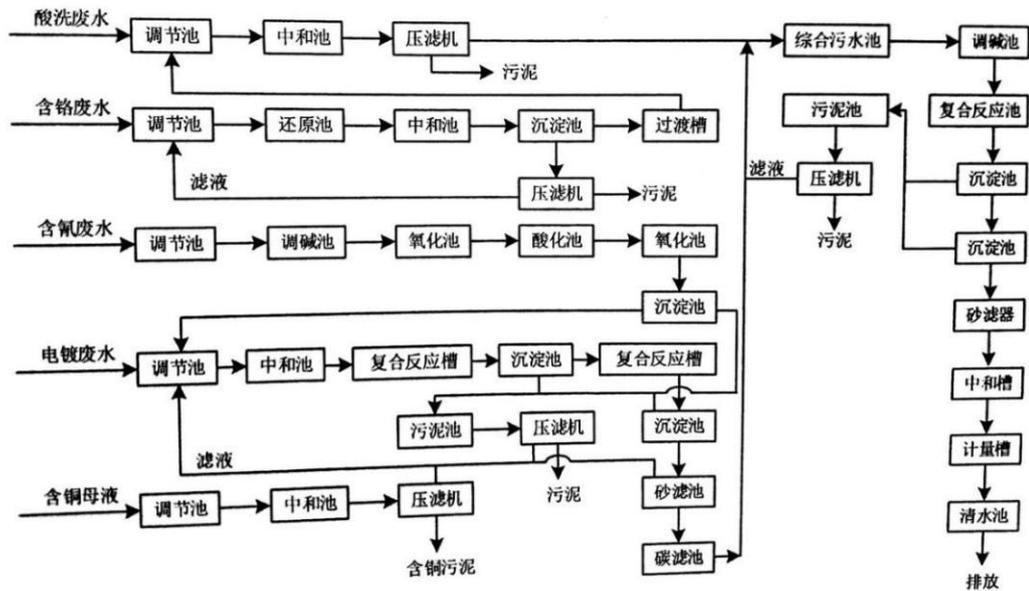
图 4-5 污水处理工艺流程图
