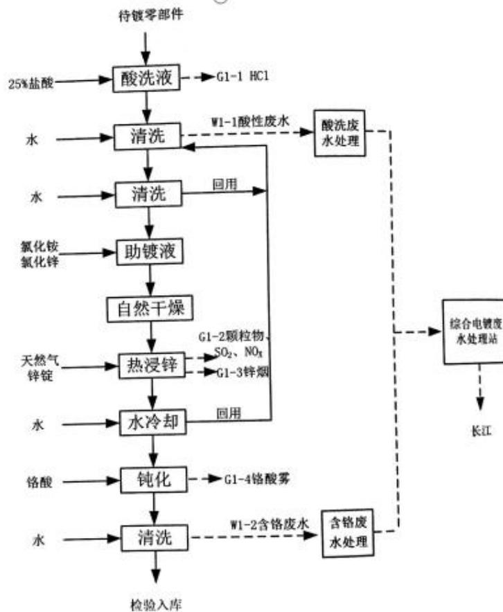
图 4-1 热浸锌工艺流程
