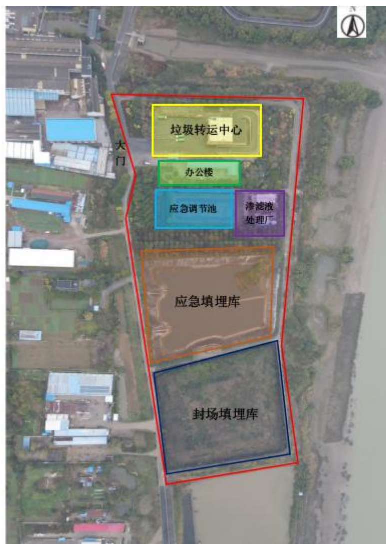
图 4.2-1 扬中市年丰垃圾填埋场平面布置图
