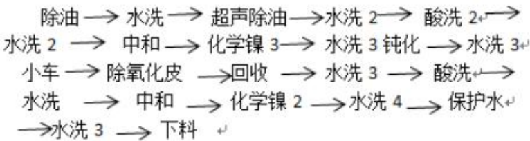
图 4-4 镀镍工艺流程
