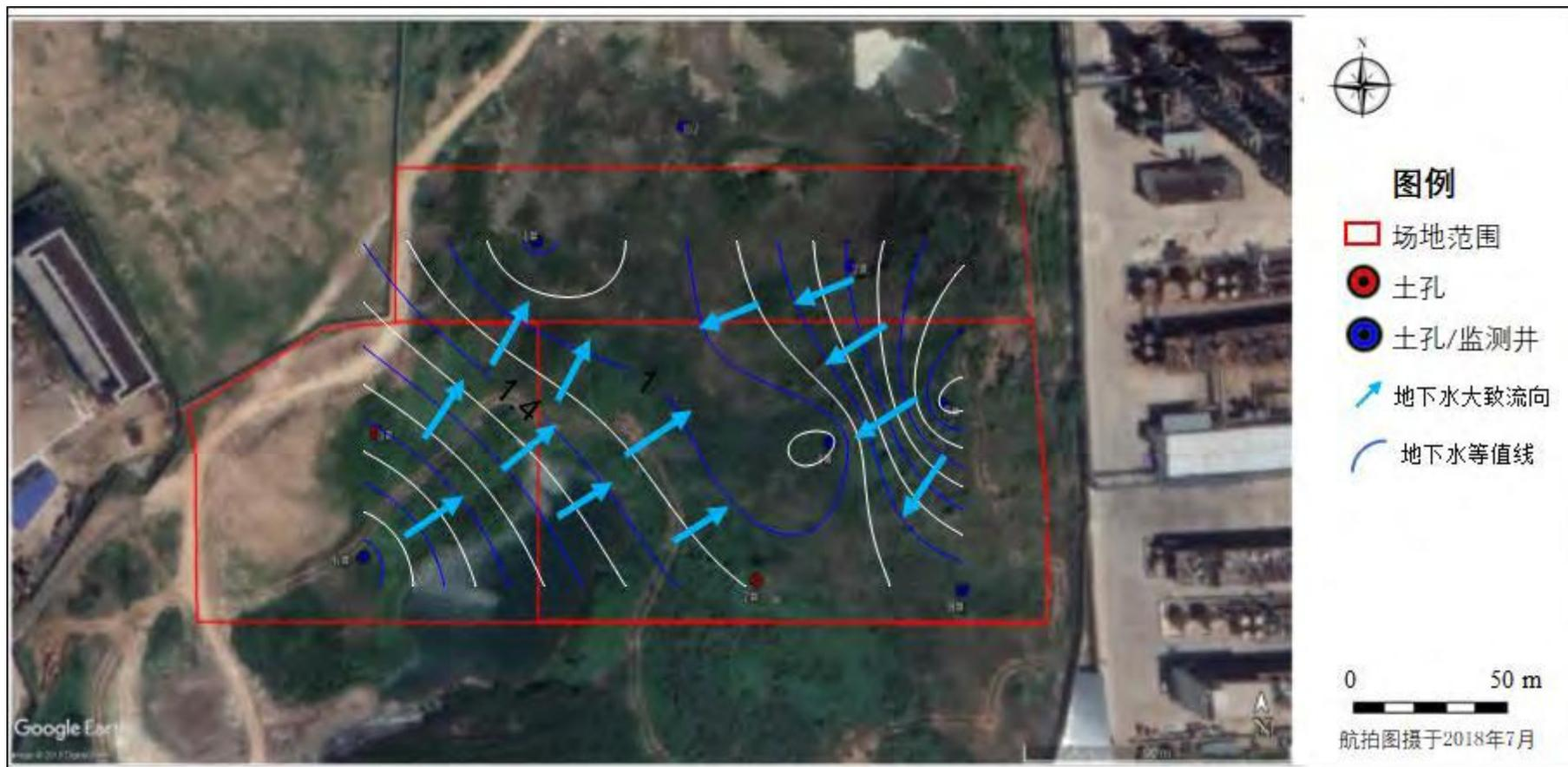
图 3.3-2 浅层地下水流向图
